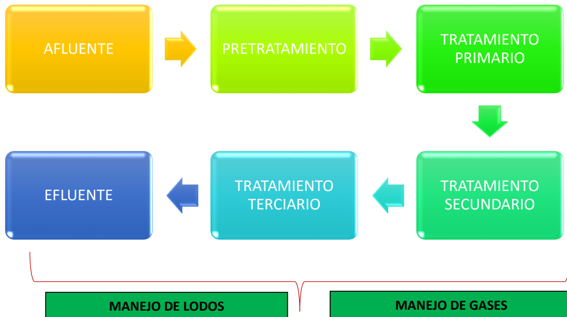
Figura 2. Etapas en una planta de tratamiento de aguas residuales.
