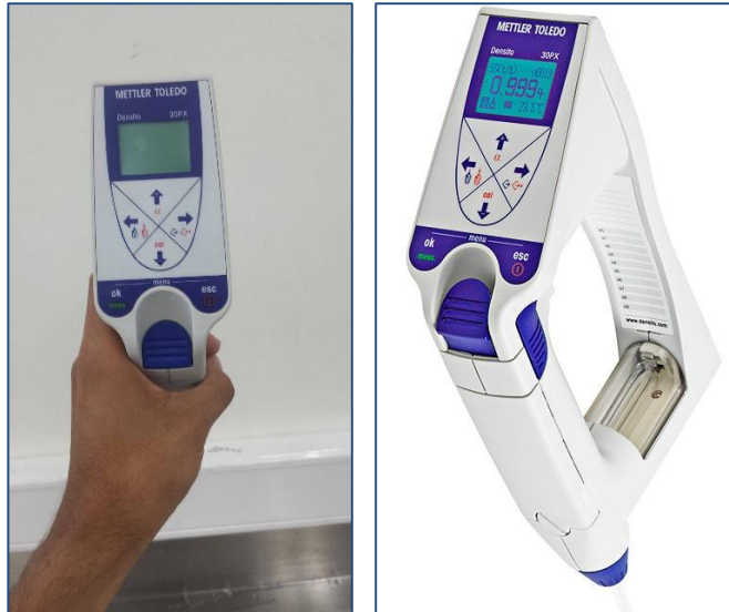
Figura 24. Densímetro Portátil DENSITO 30px METTER TOLEDO.
