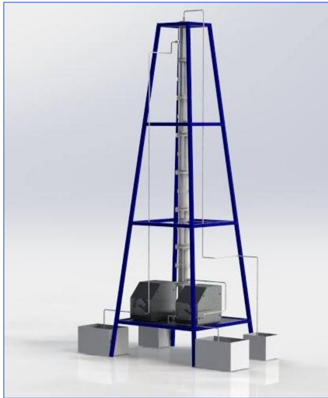
Figura 41. Columna de extracción líquido-líquido a escala laboratorio.
