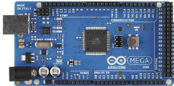
Figura 14. Arduino Mega 2560 R3
