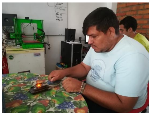
Figura 44. Prueba con gas butano proveniente de un encendedor
