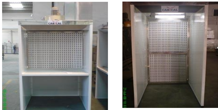
FIGURA 5 Cabinas de pintura con filtros secos para productos pequeños.
