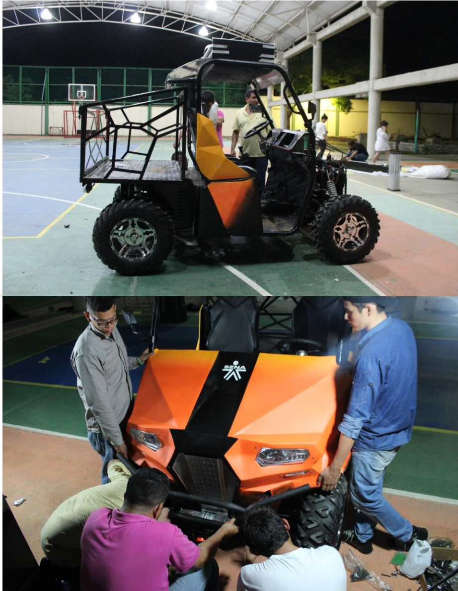
Fotografía 32 Montaje de Carrocería. Tomada por Johandra Mantilla.
