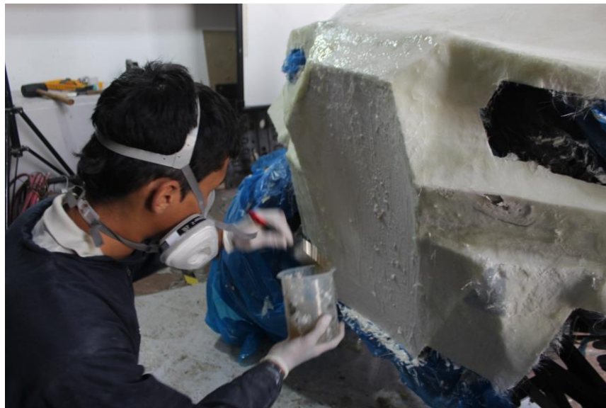
Fotografía 22 Aplicación de resina sobre modelo lateral de puerta. Tomada por Johandra Mantilla.
