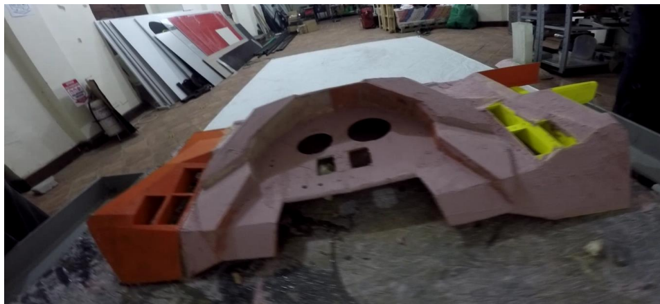
Fotografía 48, aplicación y lijado de superficie
