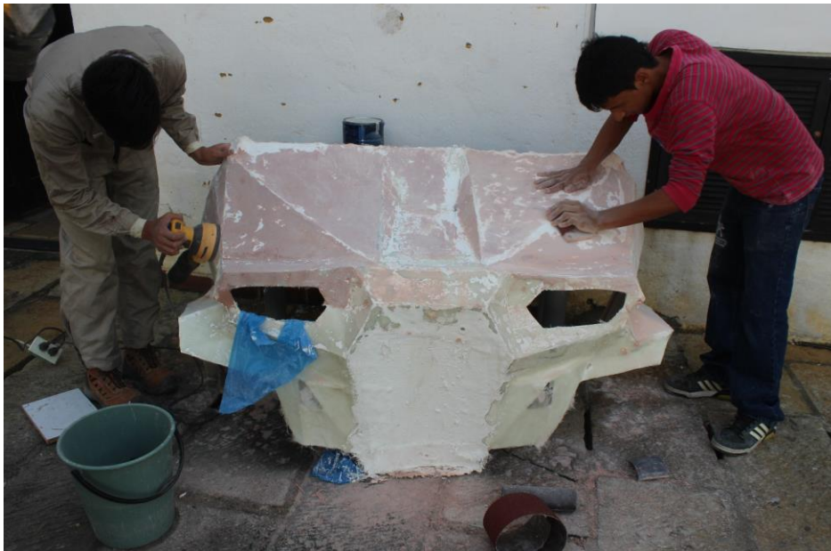
Fotografía 27 Aplicación y lijado de la masilla poliéster. Tomada Johandra Mantilla
