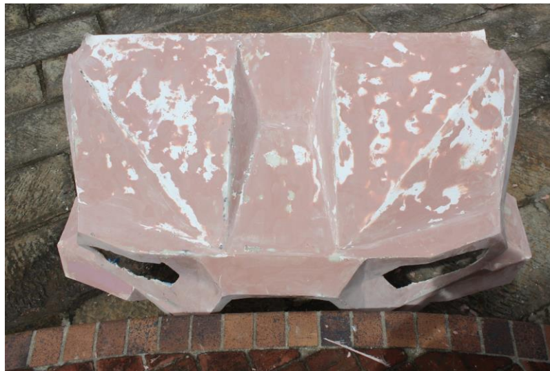
Fotografía 28 Aplicación y lijado de la masilla poliéster. Tomada Johandra Mantilla
