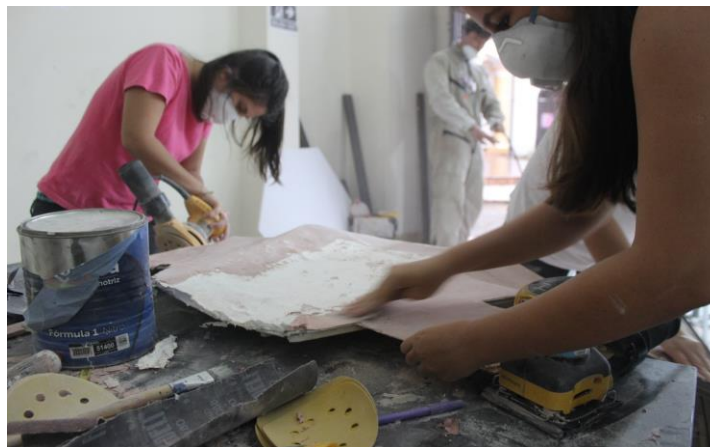
Fotografía 26 Aplicación y lijado de la masilla poliéster. Tomada Johandra Mantilla
