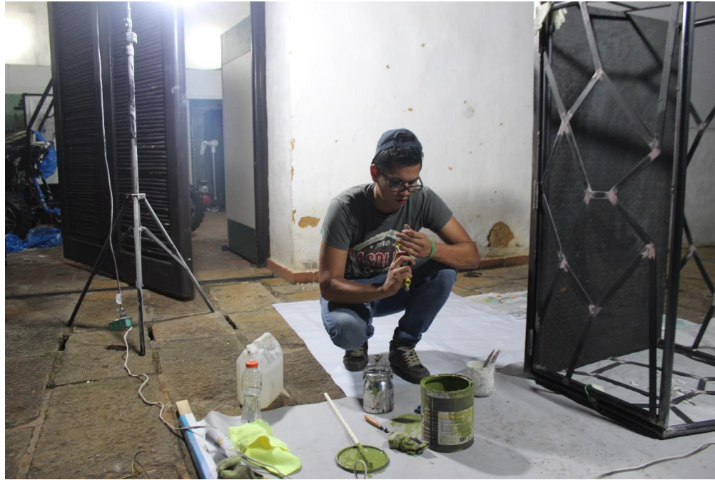
Fotografía 42, aplicación de corrosivo y pintura para jaula de carga
