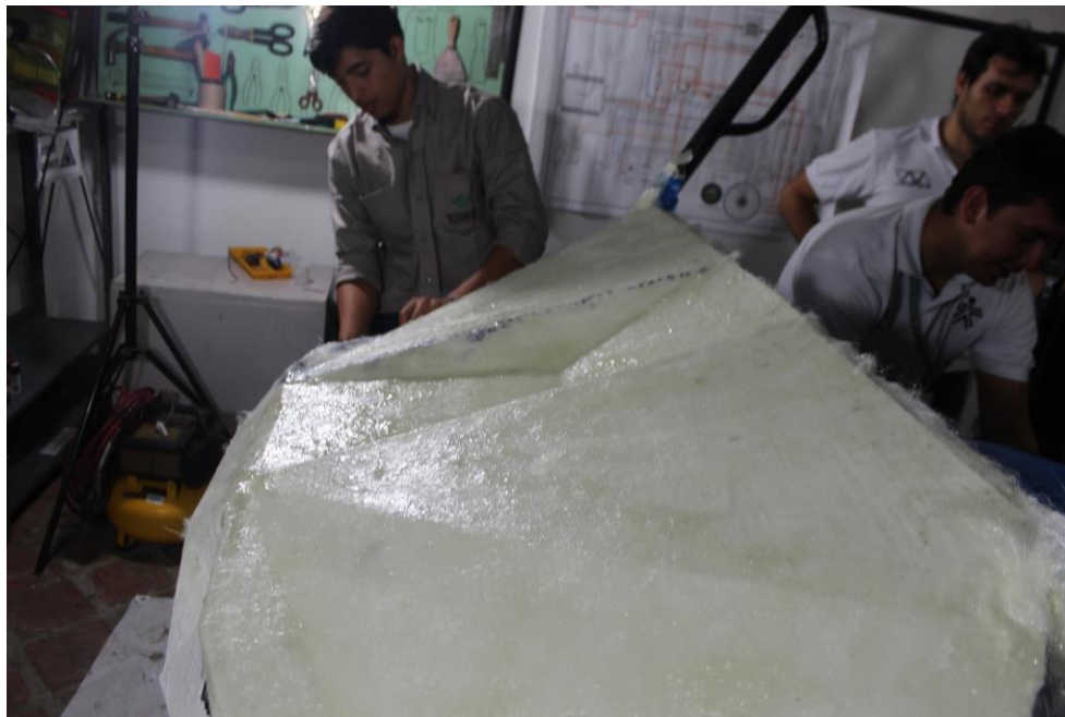
Fotografía 24 Aplicación de resina sobre modelo lateral de puerta. Tomada por Johandra Mantilla.
