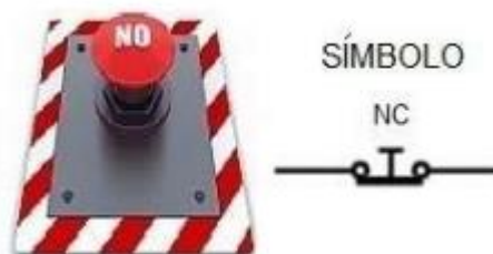
Ilustración 35 Símbolo de un interruptor pulsador NC.
