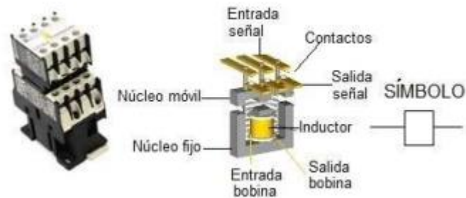
Ilustración 36 Esquema de un interruptor magnético o contactor.
