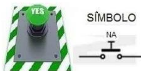
Ilustración 34 Símbolo de un interruptor pulsador NA
