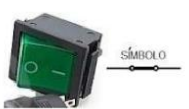
Ilustración 33 símbolo de un interruptor simple normalmente cerrado.
