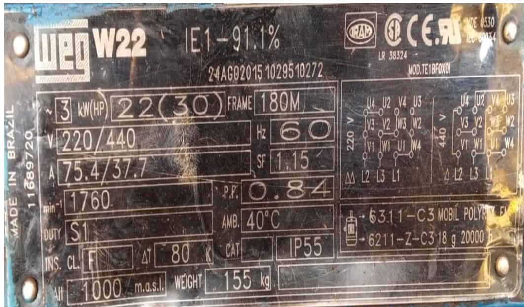
Figura 9. Placa características del motor trifásico 30 HP 220/440 V. Fuente Palmacará Ltda.
