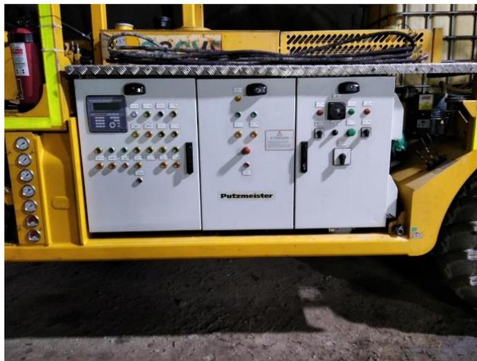
**Figura 38** Sistema electrónico de control robojet
