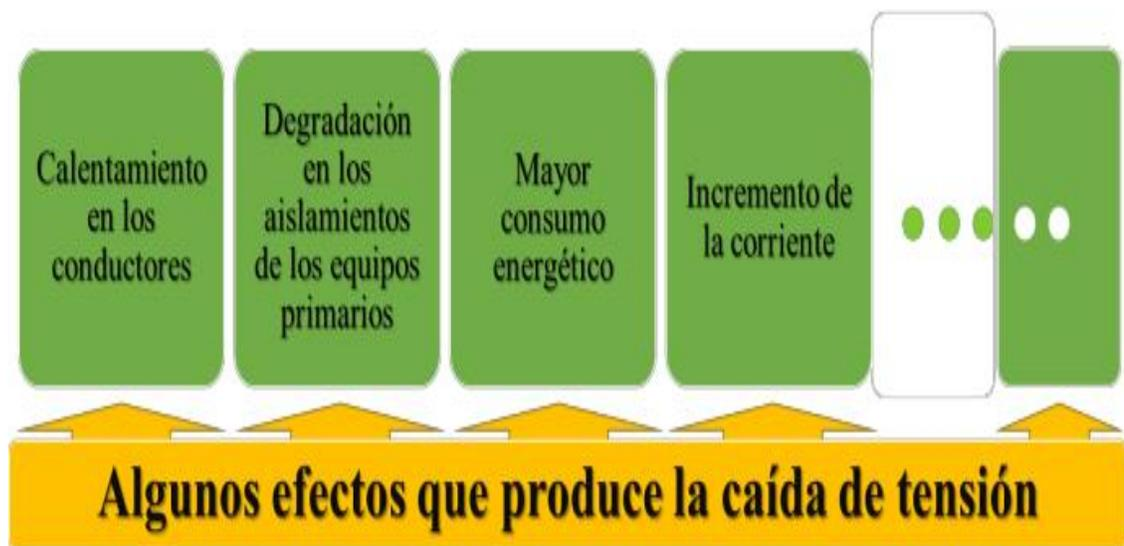
**Figura 10** Efectos de la caída de tensión en un sistema eléctrico
