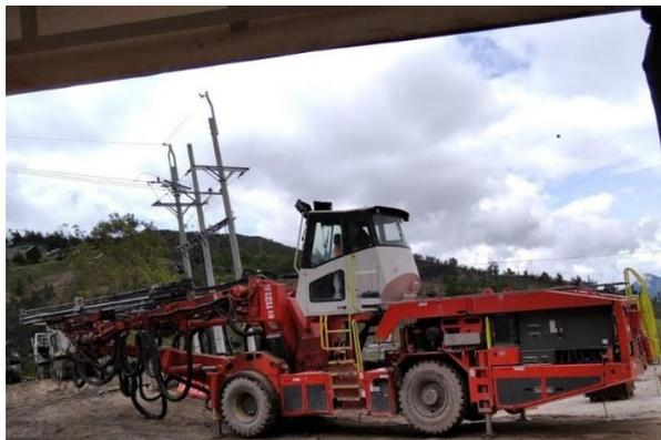
**Figura 21** Equipo de perforación para túneles sandvik DT1131
