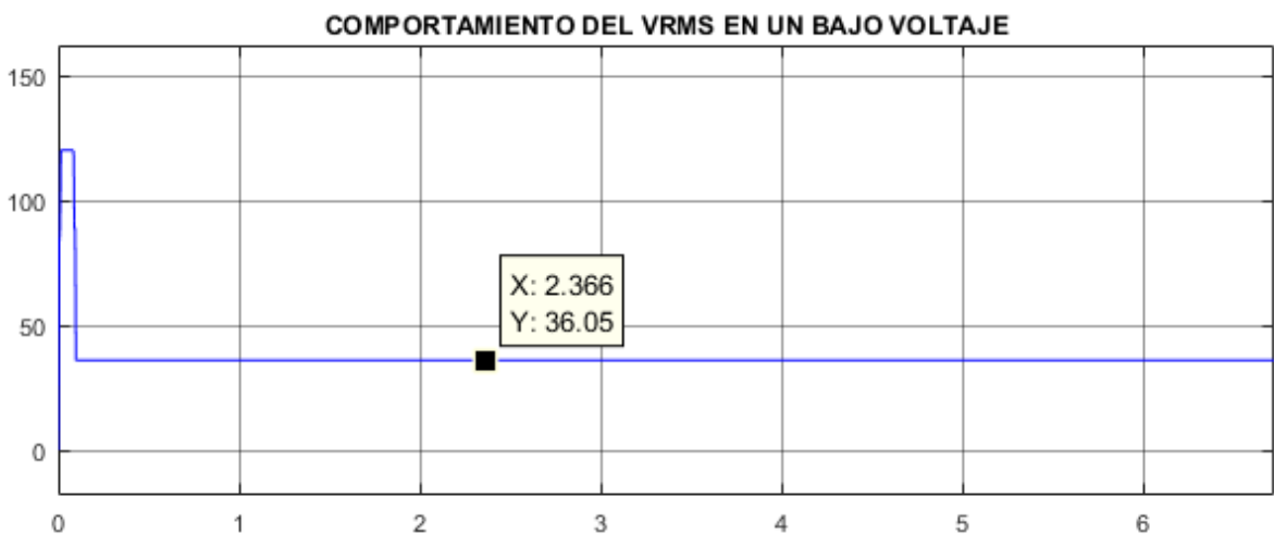
Figura 8.7: Validación del bajo voltaje simulado con el bloque RMS de la librería Power System. Fuente: Elaboración propia .
