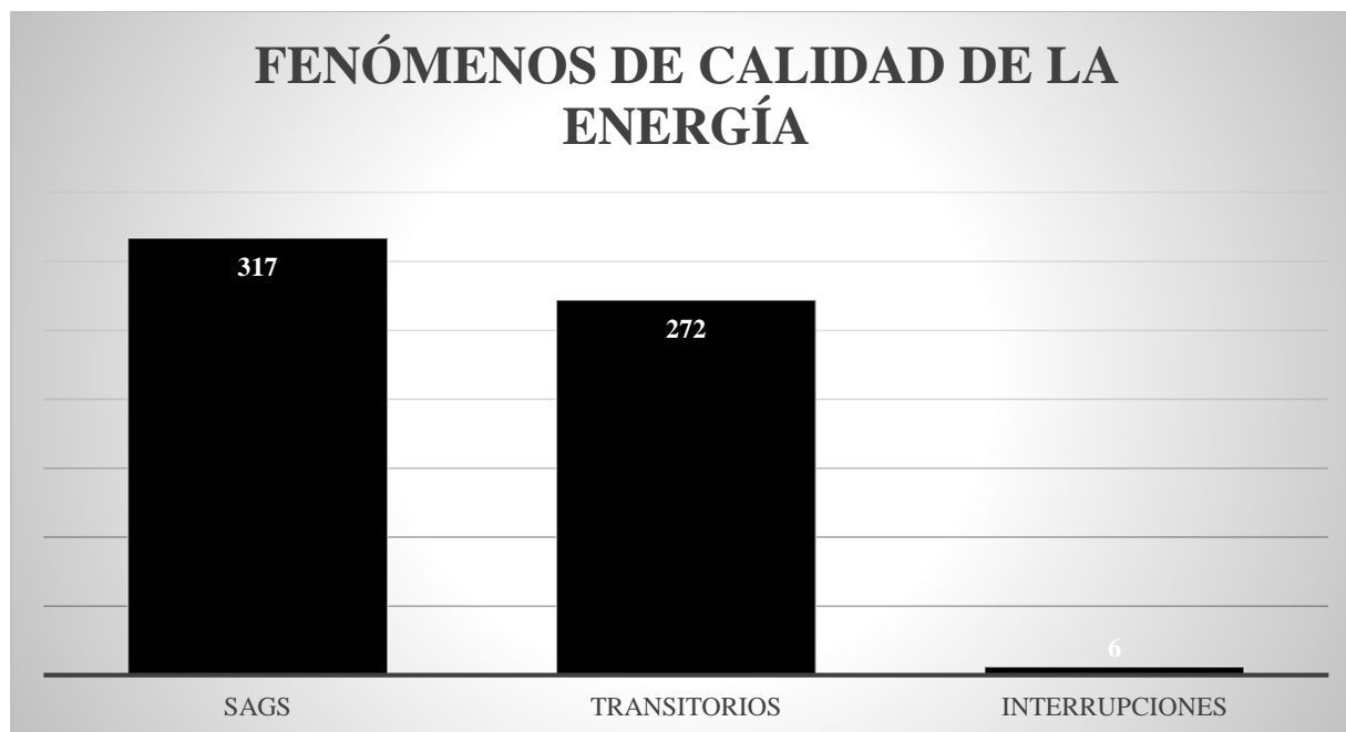
Figura 29. Número total de eventos por fenómeno de la calidad de la energía. Fuente: Autor
