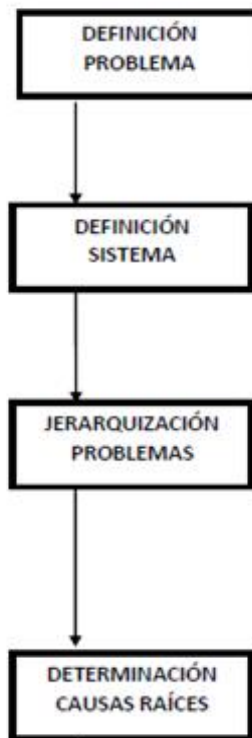
Figura 13. Esquema de la metodología del análisis causa raíz RCA. Fuente: (A D Livingston (2001)).
