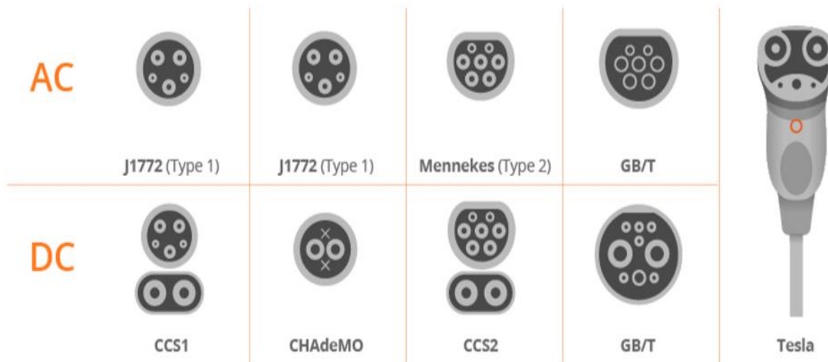
Ilustración 19. Distintos tipos de conectores usados en vehículos eléctricos. (CONSORCIO USAENE, 2019)
