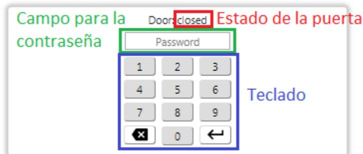
Figura 17. Panel de control y monitoreo para la puerta en la interfaz. Fuente: Autor.
