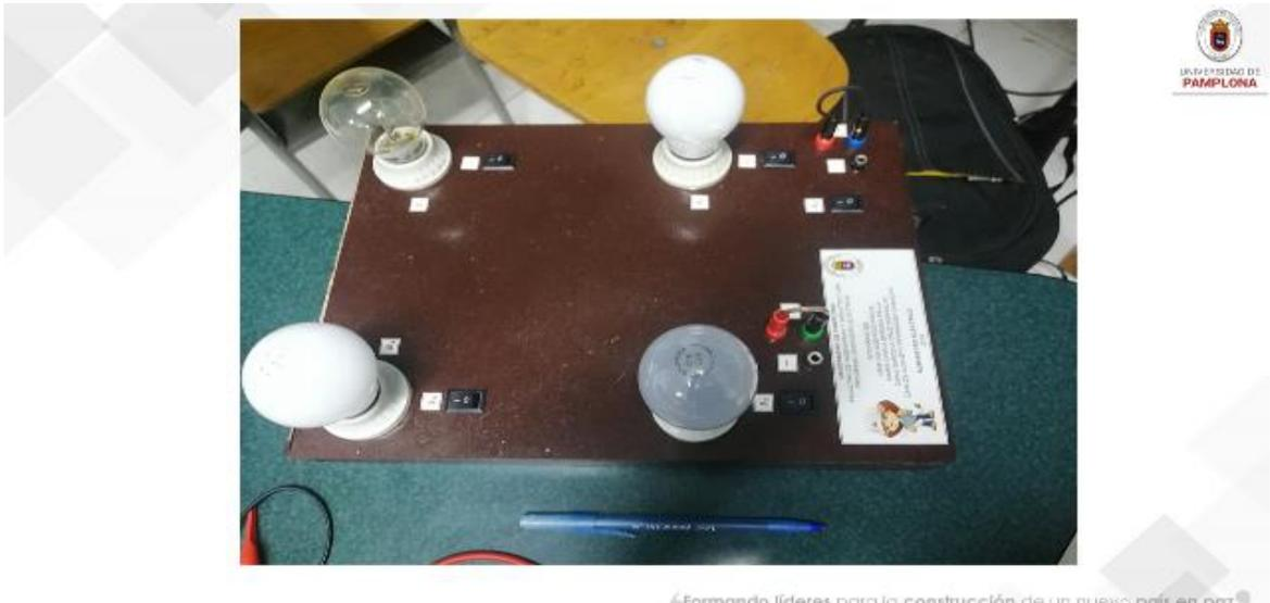
**Ilustración 57.** Instalación del circuito eléctrico con bombillos incandescentes.
