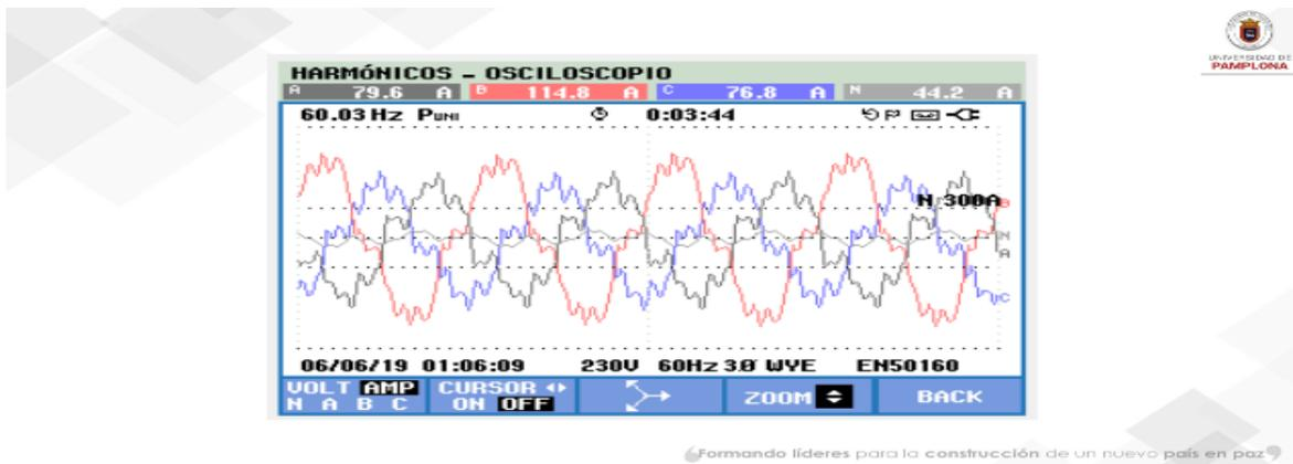
**Ilustración 92. Ondas de corriente**
