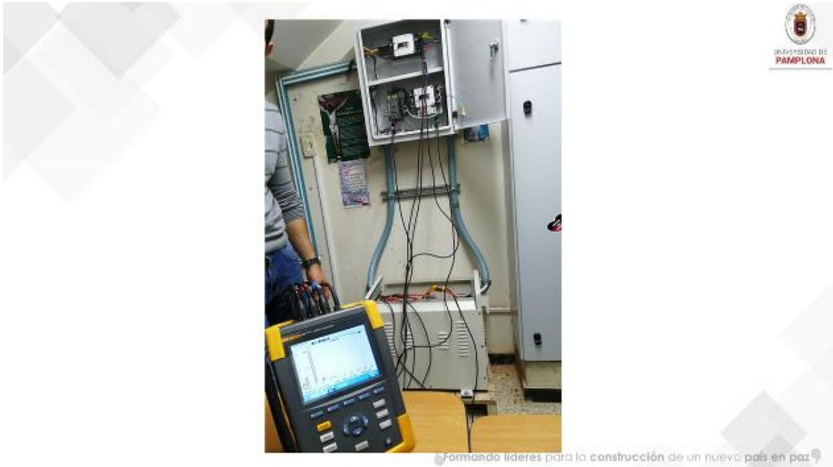
**Ilustración 75.** Instalación del analizador de redes.
