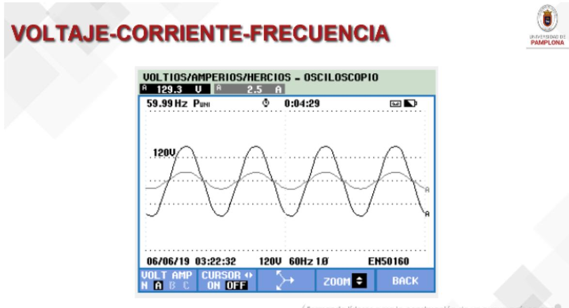
**Ilustración 62.** Ondas de voltaje y corriente con bombillos incandescentes.
