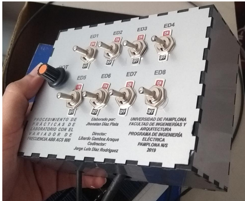
Figura 39. Finalización de la caja para el control de las entradas digitales
