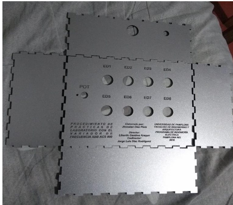
Figura 35. Diseño de la caja para el control de las entradas digitales
