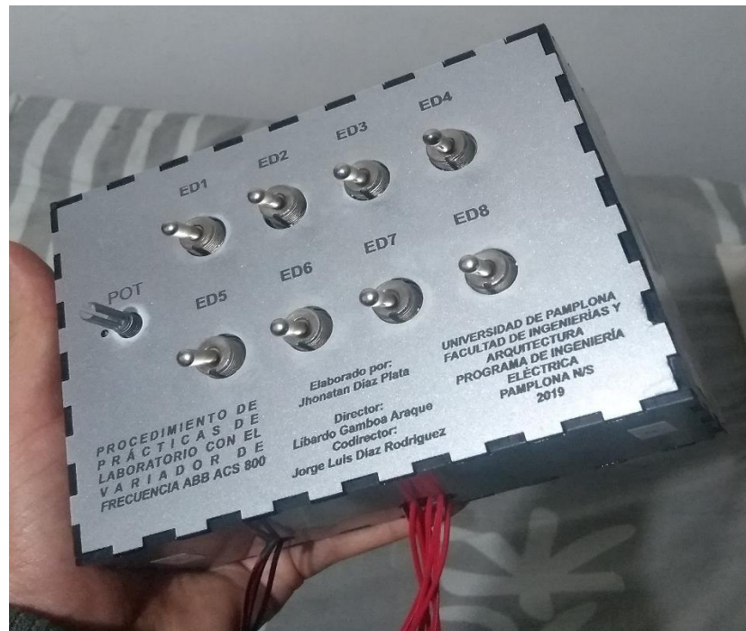
Figura 38. Unión de todas las partes de la caja para el control de las entradas digitales
