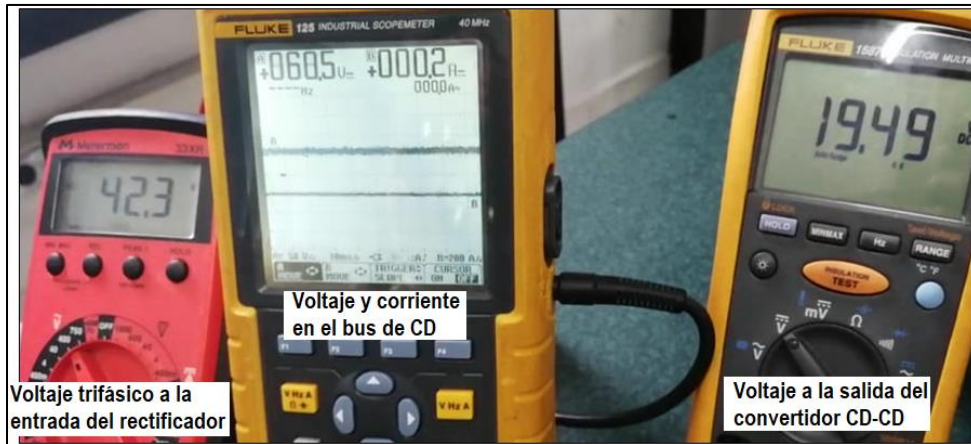
Figura 87. Formas de onda y valores de tensión y corriente a la salida del convertidor CD-CD, comportándose como reductor
