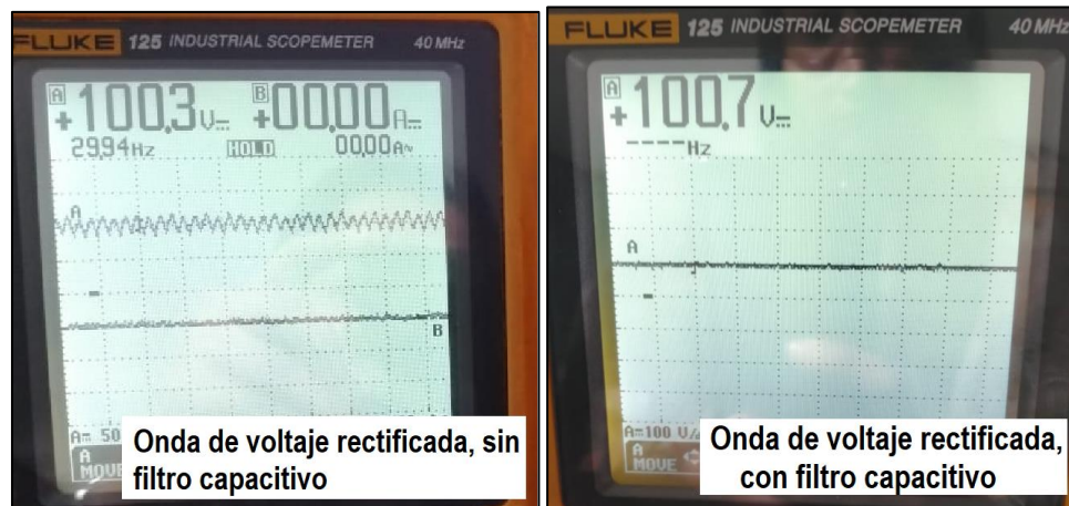
Figura 85. Forma de onda y valor de la tensión a la salida del rectificador trifásico
