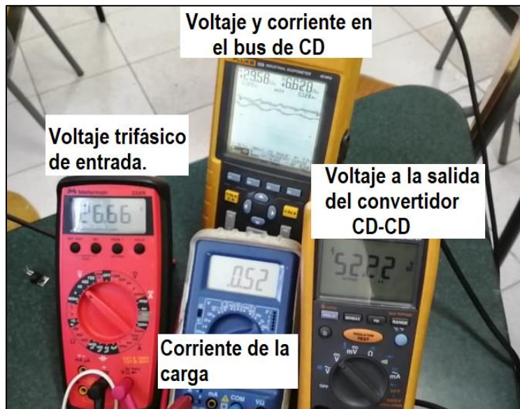
Figura 90. Formas de onda y valores de tensión y corriente a la salida del convertidor CD-CD comportándose como elevador
