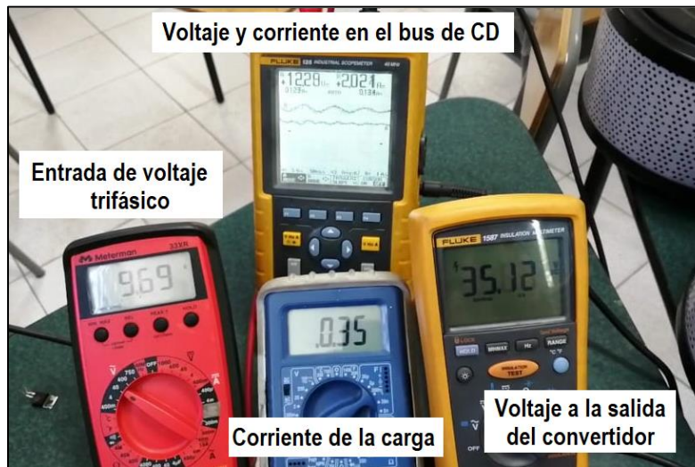
Figura 91. Formas de onda y valores de tensión y corriente a la salida del convertidor CD-CD comportándose como elevador
