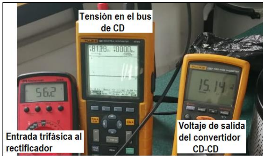
Figura 88. Formas de onda y valores de tensión y corriente a la salida del convertidor CD-CD, comportándose como reductor, 2da prueba
