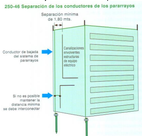
Figura 22. separación de los conductores de bajada del sistema de protección contra descargas atmosféricas.
