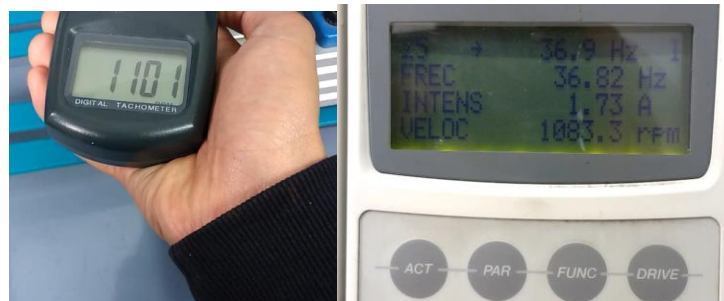
Ilustración 4. 32 Medidas de velocidad por debajo de la nominal. Fuente: Autor
