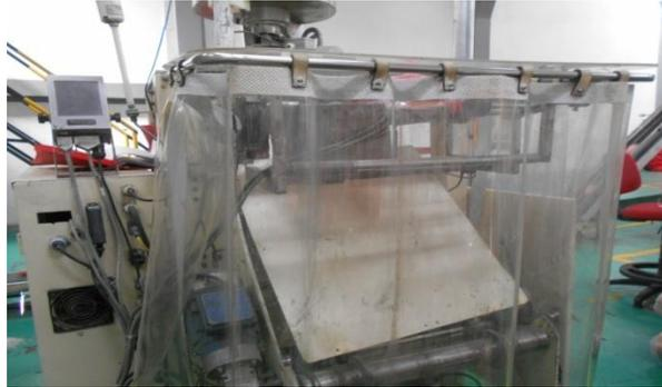
**Figura 4.** Protección dispuesta al rollo de lámina
