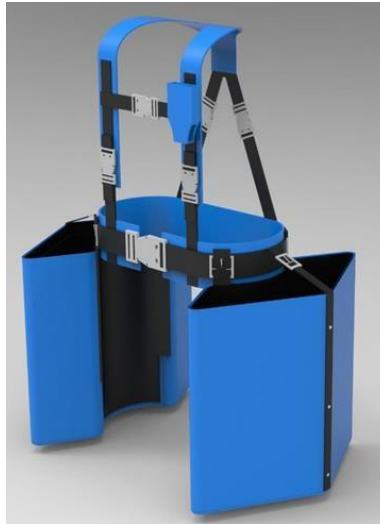
Figura 39. Rediseño final del recolector de naranja
