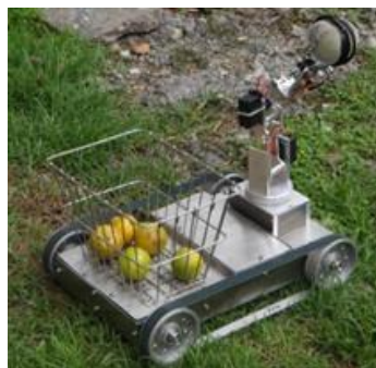
Figura 7. Implementación de una plataforma móvil para recolección de naranjas
