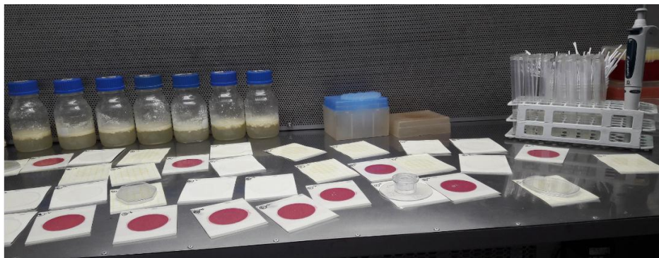
Foto 5. Muestreo microbiológico de muestras de crema de leche cruda con tratamiento ultrasonido. Fuente: Autor.
