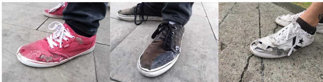
Ilustración 6 Zonas del calzado dañadas por el truco del Ollie. Autor
