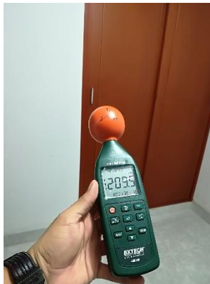
Figura 41. Medición indoor sin presencia de equipos de tecnología inalámbrica
