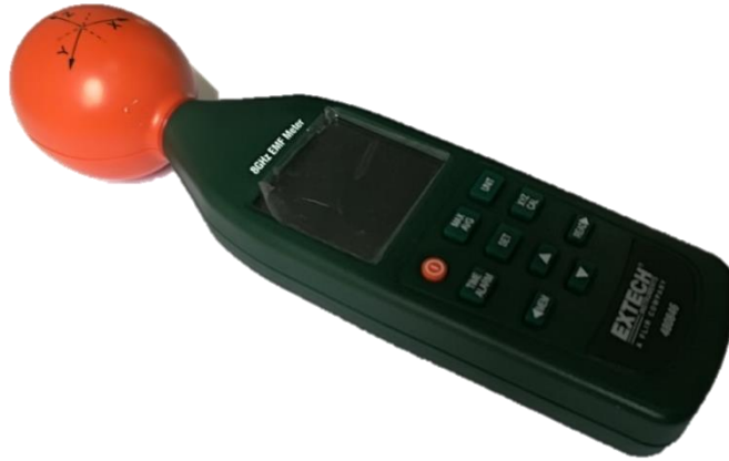
Figura 39. Equipo medidor de intensidad de RF CEM EXTECH INSTRUMENTS Modelo 480846
