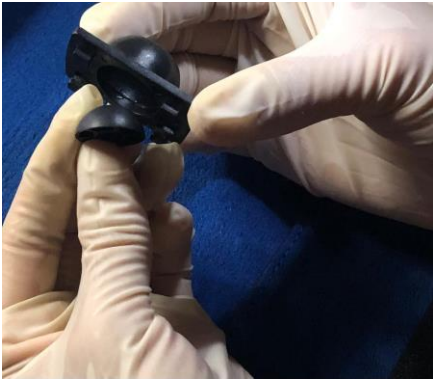
Figura 137 Verificación camisa y alojamiento
