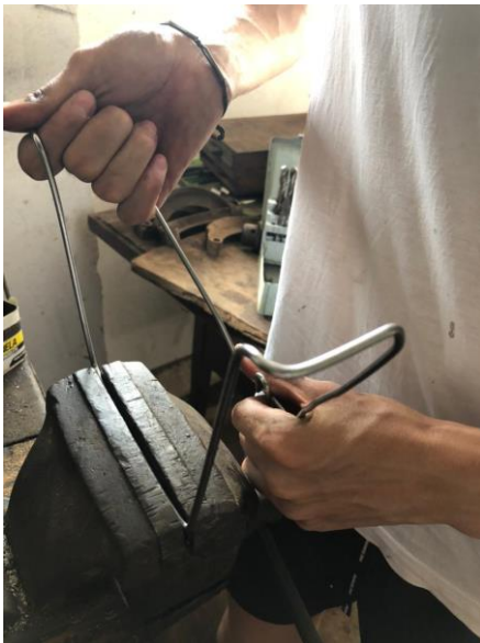
Doblado del alambre en prensa
