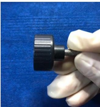
Figura 142 Verificación de la rosca y el tornillo
