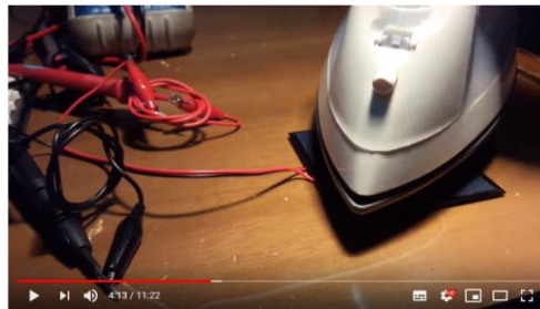
Figura 69: Método para calentar la célula fotovoltaica.
