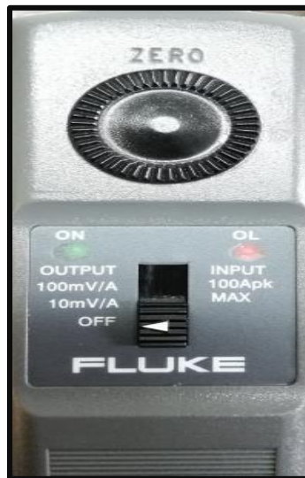
Fig. 50. Disposición física del escalamiento de la Sonda de corriente CA/CC 80i-110s
