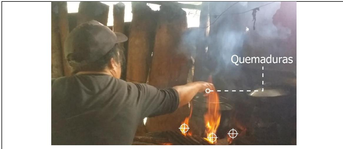
Descripción: En la estufa tradicional se identifica como se desperdicia la energía del fuego en varios puntos, causando que se necesite más tiempo y leña para la cocción. Este escape de poder calorífico al costado de la olla se vuelve en un peligro de quemaduras para el usuario mientras revuelve los alimentos o coloca las respectivas tapas de las ollas.
