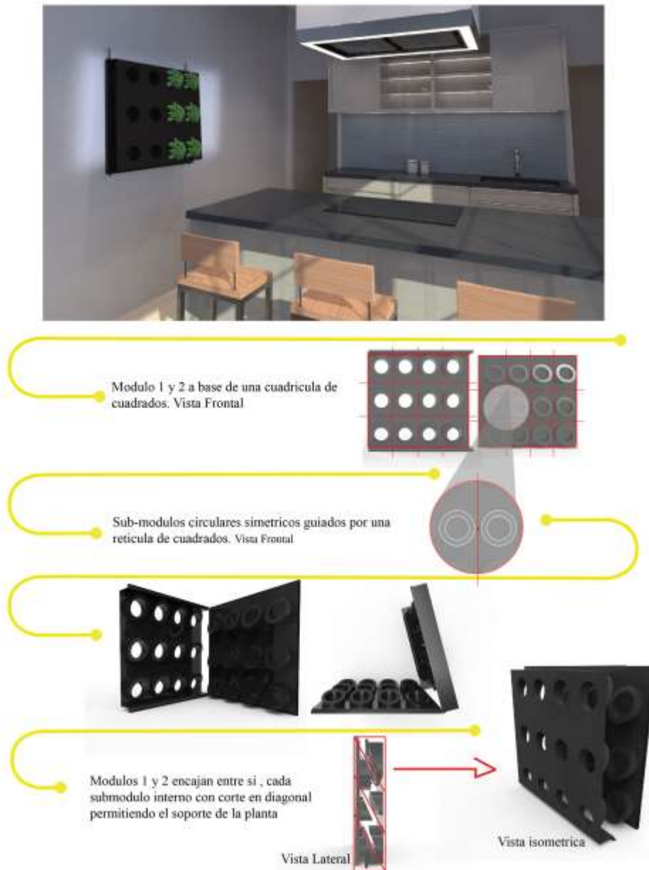
Ilustración 33. Alternativa 3, generación de una pieza modular para la composición de un jardín vertical, fuente propia
