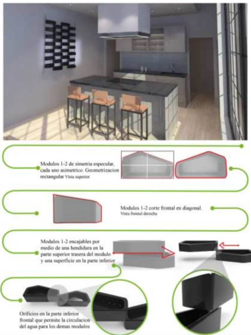
Ilustración 20. Alternativa 1, generación de una pieza modular para la composición de un jardín vertical, fuente propia.
