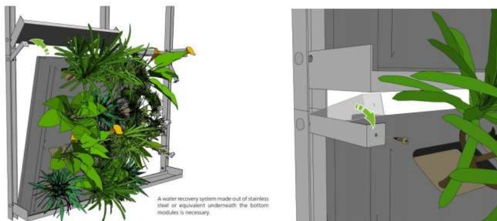
Ilustración 12 Montaje de los módulos plantados en la estructura metálica. Fuente Projar Group
