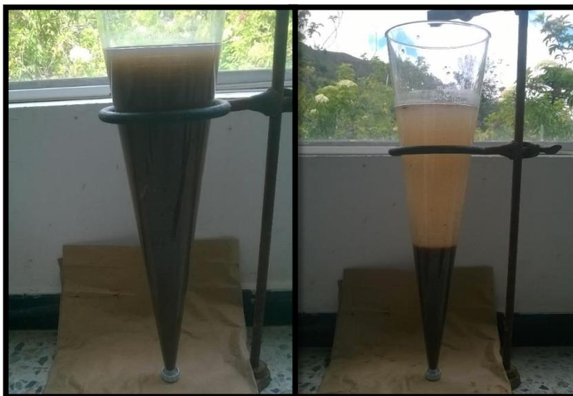
Figura 6. Evaluación de sólidos sedimentables antes y después de 1h. Fuente: Autor. Técnica digital. Laboratorio de Biotecnología. Universidad de Pamplona
