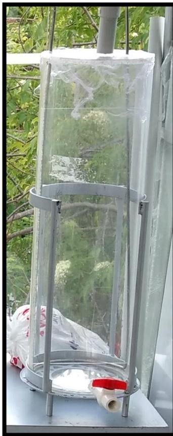
Figura 13. Fotorreactor airlift. Fuente: autor. Técnica digital. Laboratorio de Biotecnología.
