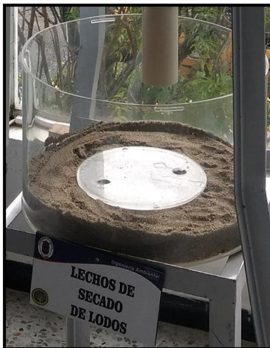
Figura 10. Lechos de secado de lodos. Fuente: autor. Técnica digital. Laboratorio de Biotecnología. Universidad de Pamplona
