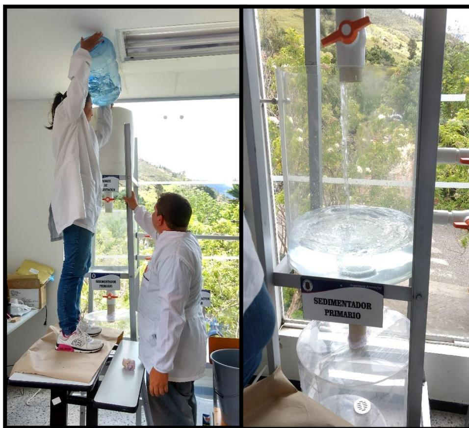
Figura 19. Prueba hidráulica del sistema. Fuente: autor. Técnica digital. Laboratorio de Biotecnología. Universidad de Pamplona
