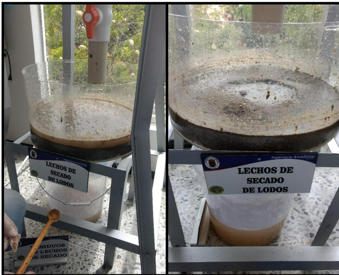
Figura 24. Lodo residual del sedimentador primario en los lechos de secado. Fuente: autor.
