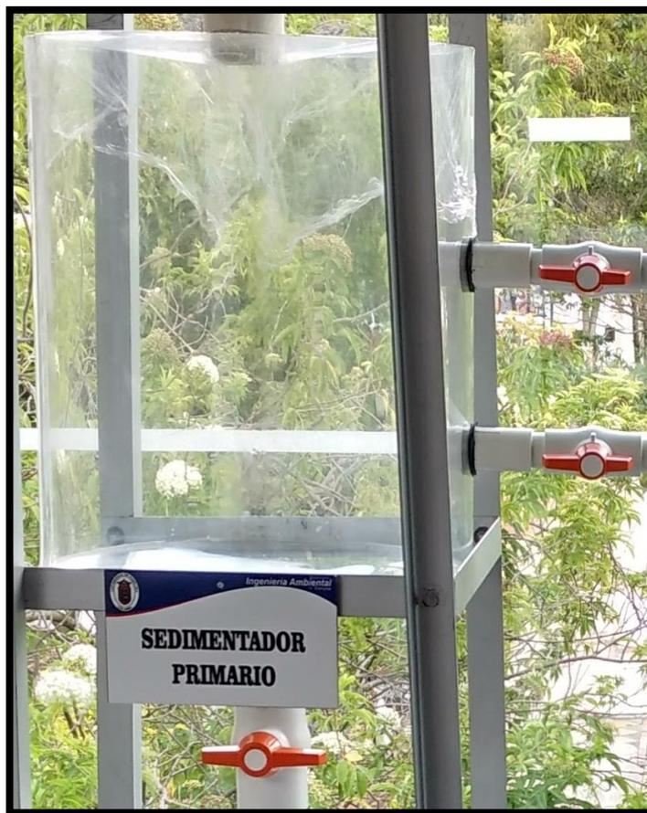
Figura 8. Sedimentador primario Fuente: autor Técnica digital. Laboratorio de Biotecnología.
