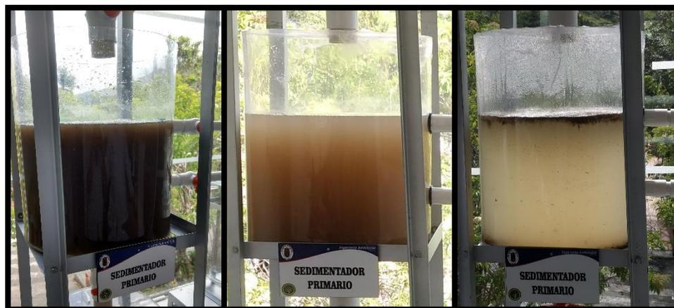
Figura 21. Sedimentador primario con un tiempo de retención de 0, 1.5 y 3 h. Fuente: autor.
