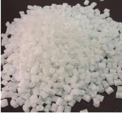
El PET es una resina altamente flexible, incolora y semicristalina en su estado natural. Dependiendo de cómo se procese, puede ser semirrígido a rígido. Muestra buena estabilidad dimensional, resistencia al impacto, humedad, alcoholes y solventes.
