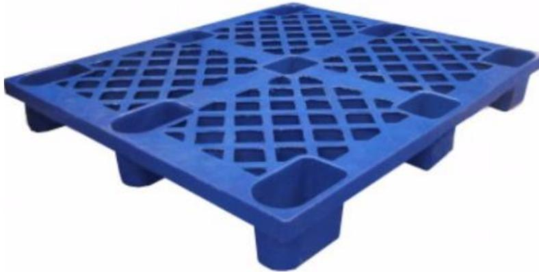
Este tipo de estibas es fabricado por inyección y esta elaborada en polietileno de alta densidad 100% reciclable, cuenta con cuatro entradas para montacargas, tiene 1200x1000x150mm, pesa 8Kg y tiene carga dinámica de 800Kg y una carga estática de 2000Kg.
