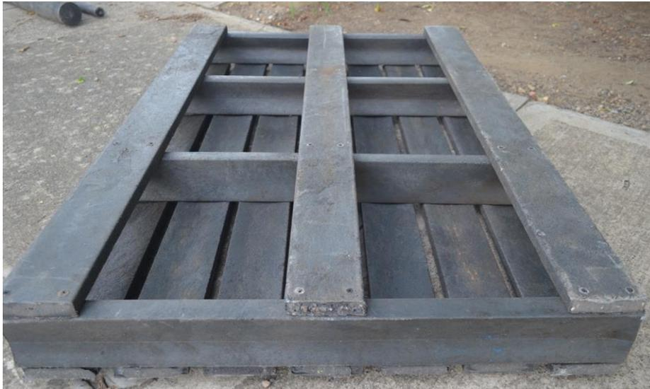
Las estibas están elaboradas por tablas de Aglopet unidas por tornillos para drywall de 3 pulgadas, fueron llevadas a una de las bodegas de Ceramica Italia donde se pusieron a prueba por 48 horas con una carga de 5,5Ton. El resultado de la prueba fue positiva ya que no se generó rotura ni ningún tipo de deformación, además de la facilidad del montacargas para moverlas con peso igual a una estiba normal de madera, esto dio luz verde para continuar con el proyecto de las estibas desarmables.
