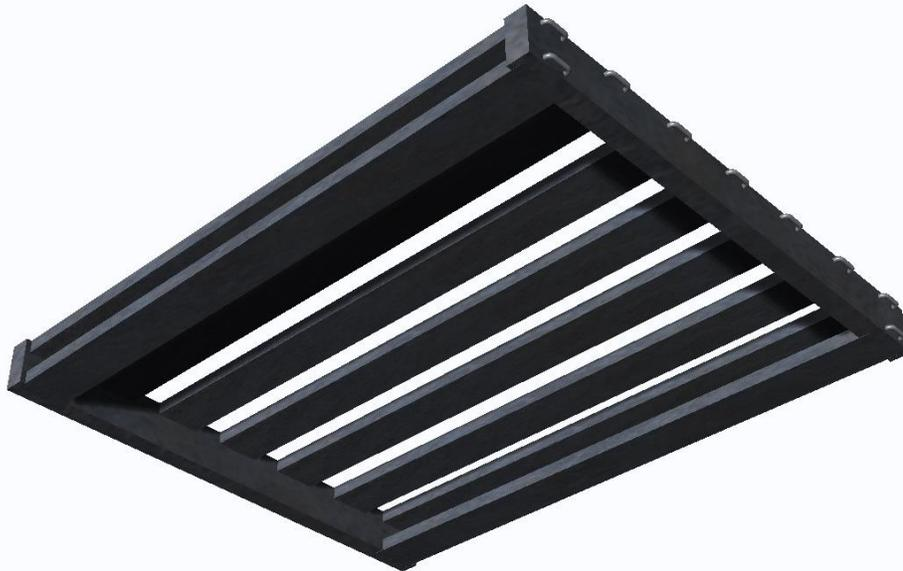
Estiba americana que consta de 29 piezas: nueve tablas de 2,5cm x 9cm x 120cm y dos perforaciones de 8mm, dos laterales de 4cm x 9cm x 100cm, cada lateral 9 cortes 9x2x2cm y dos perforaciones de 8mm por sección, 9 ganchos metálicos de 8mm x 15cm doblados y con puntas redondeadas. Las tablas se encajan en los laterales y los ganchos son insertados a presión para asegurar y mantener estable la estructura de la estiba.
