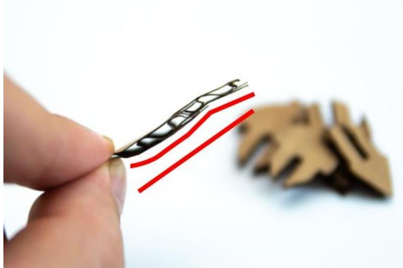
*Ilustración 29 Comprobación, deformación por compresión. Elaboración propia.*
