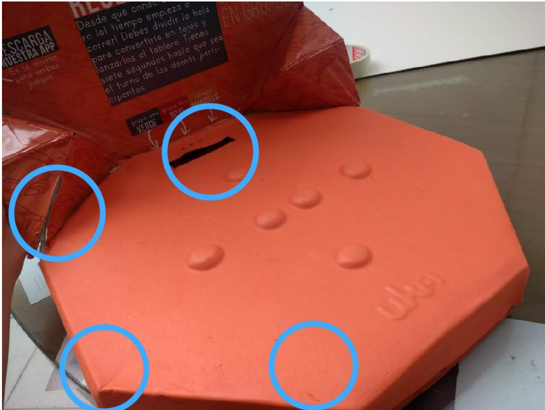
Ilustración 35 Evidencia del maltrato por impacto.
