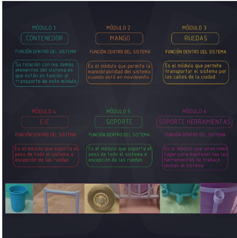
Ilustración 7 relación que existe entre cada uno de los módulos con las demás partes del sistema y su papel dentro del mismo
