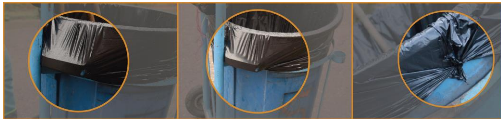
Fotografía 28 daños que sufre la bolsa debido al ajuste actual
