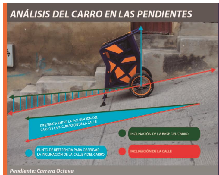
Ilustración 12 Análisis del carro en las pendientes
