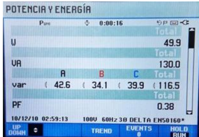
Figura 66. Potencia en vacío conexión d-d
