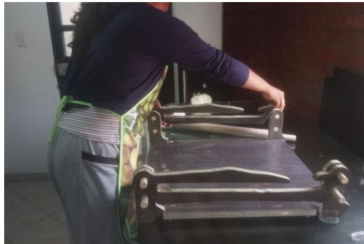
Ilustración 55 Agarre de guías laterales
