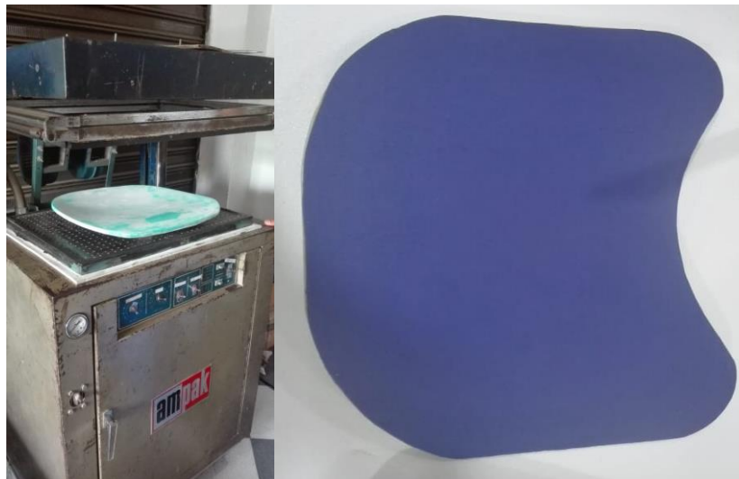
Ilustración 132[Fotografía de Daniela Carrero]. (Bucaramanga. 2018). / Módulos pintados y preparados para termoformar para el modelo de comprobación
