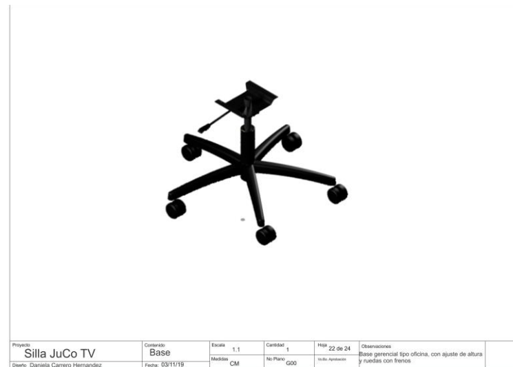
Ilustración 126 [Daniela Carrero]. /Planos técnicos y despiece - Base Silla
