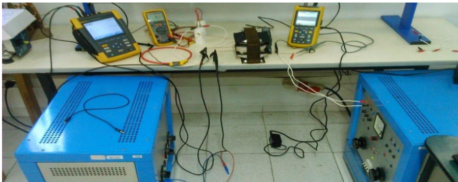
Figura 28. Conexión del transformador básico ferroresonante de acuerdo al esquema anterior.
