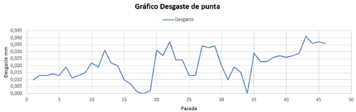
Fig. 51. Gráfico desgaste de punta.
