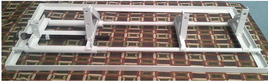
Figura 55. Estructura de soporte y acople de las maquinas.
