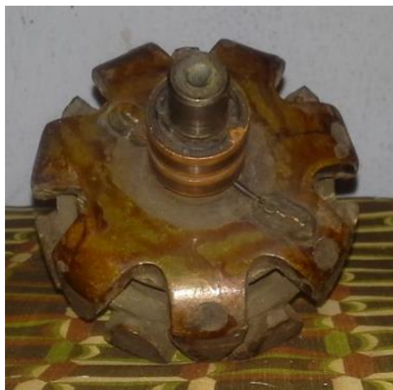
Figura 34. Rotor de 7 polos intercalados maquina Delco Remy
