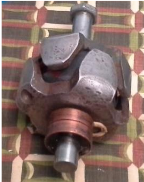
Figura 35. Rotor de polos intercalados de 8 polos maquina Prestolite.
