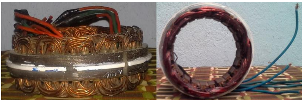
Figura 51. Estatores de las maquinas con conectores
