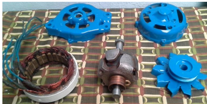
Figura 53. Partes de la maquina Prestolite después de ser adecuadas
