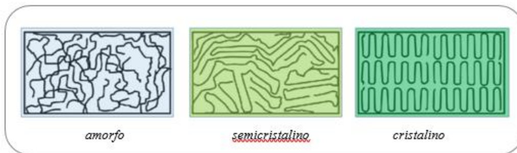
Figura 4. Fase amorfa, semicristalina y cristalina de un polímero según Beltran y Mancilla (2012).
