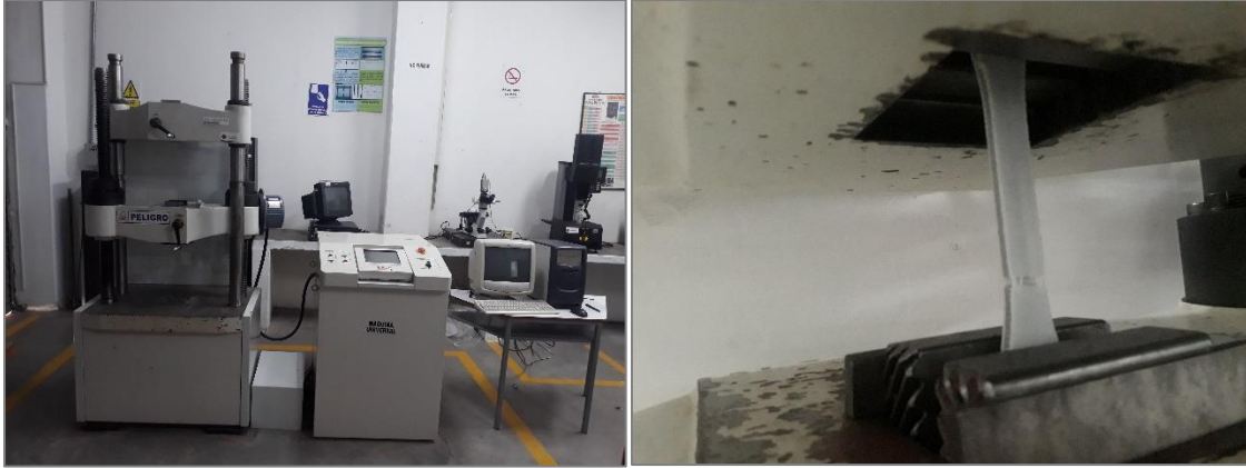
Figura 46. Máquina Universal Shimadzu de ensayos UH 600 kNI y mordazas para ensayos de tensión.
