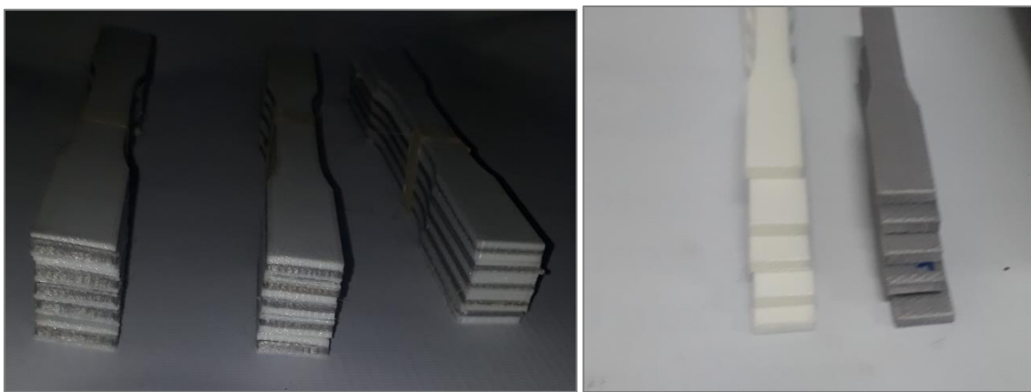
Figura 47. Probetas de mezclas heterogéneas y materiales puros fabricadas para ensayos de tracción.
