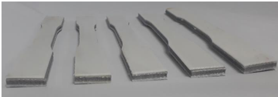
Figura 45. Probetas de tracción fabricadas con mezclas heterogéneas de materiales poliméricos.
