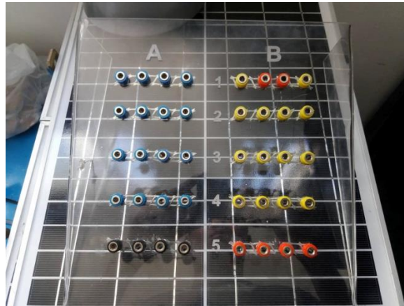
Figura 44: Tablero de conexión. Fuente: el autor
