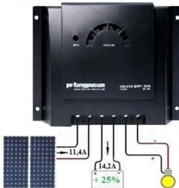
Figura 38: Esquema de conexión del regulador. Fuente: https://solar-energia.net/energia-solar-fotovoltaica/elementos/instalaciones-autonomas/reguladores-carga
