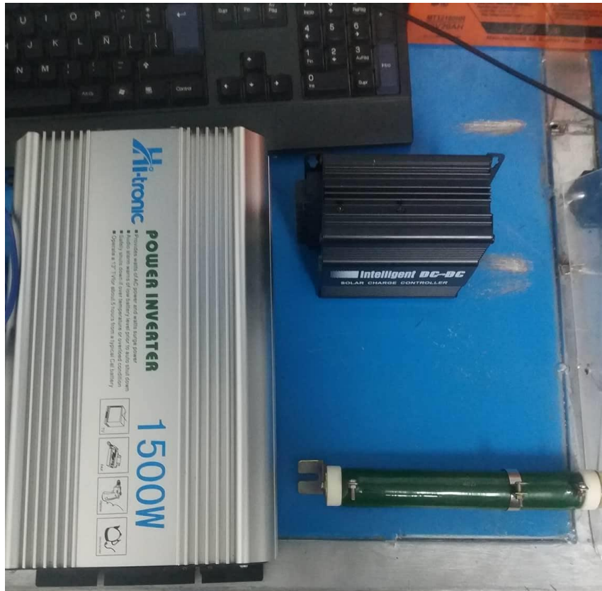
Figura 58: Inversor, Resistencia, Regulador
