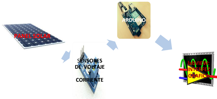
Figura 21: Diagrama de bloques de la interfaz grafica. Fuente: el autor
