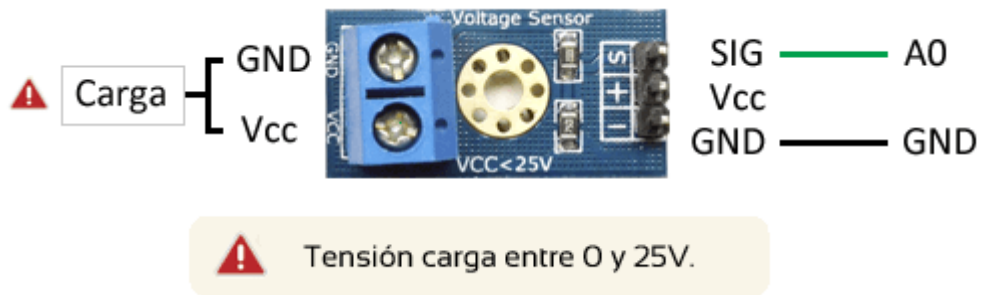
Figura 26: Esquema de montaje: fuente: https://www.luisllamas.es/medir-voltajes-de-hasta-25v-con-arduino-y-fz0430/
