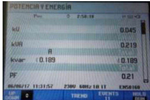
Figura 166 Parámetros de potencia y factor de potencia prueba de vacío realizada en el lado de baja tensión transformador monofásico visualizados a través del analizador de red de marca Fluke
