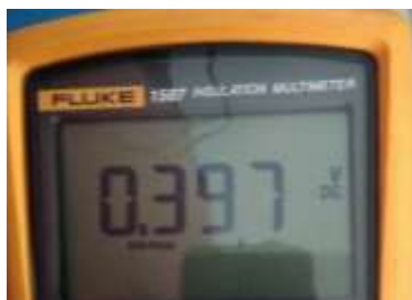
Figura 161 Prueba DC para el transformador monofásico realizada en el lado de baja tensión referida al primario.
