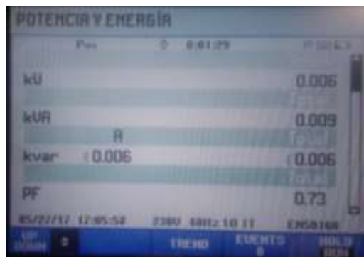
Figura 128 Potencia de vacío para el segundo test para la caracterización del material ferromagnético
