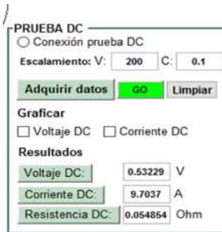
Figura 117 Prueba DC realizada por el lado de baja del transformador monofásico
