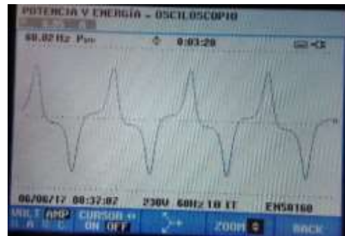
Figura 143 Prueba de vacío transformador monofásico realizada en el lado de alta tensión.
