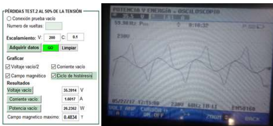
Figura 127 Segunda prueba de vacío con una tensión de alimentación del transformador por el lado de baja de 35.5 V
