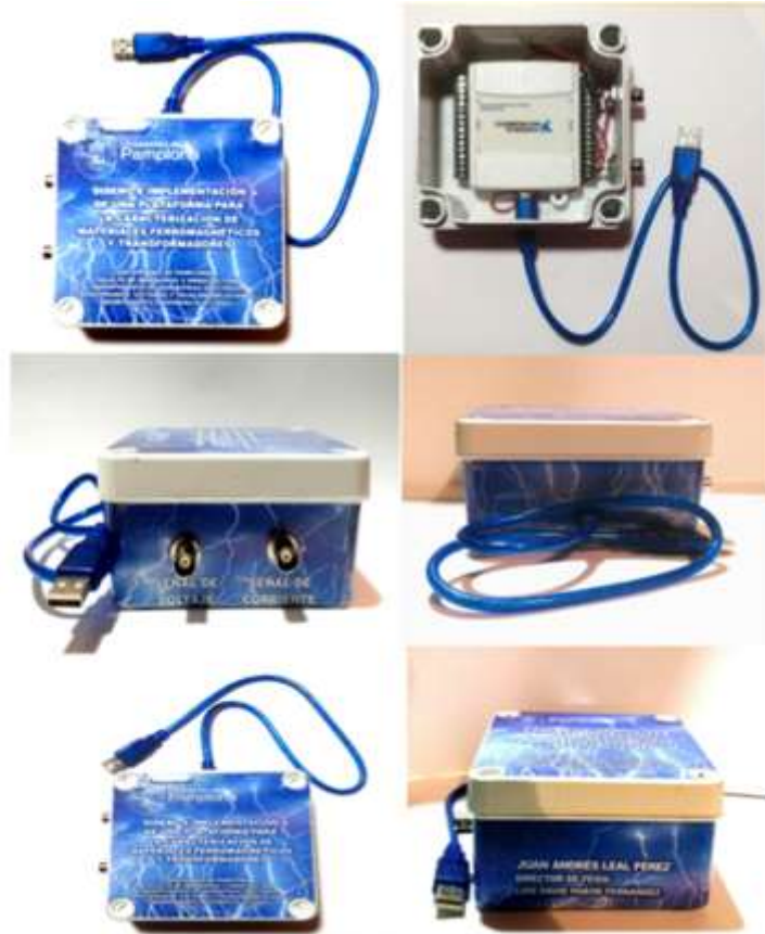
Figura 62 Diferentes vistas de las partes del hardware de adquisición de datos para la plataforma de caracterización de materiales ferromagnéticos y transformadores
