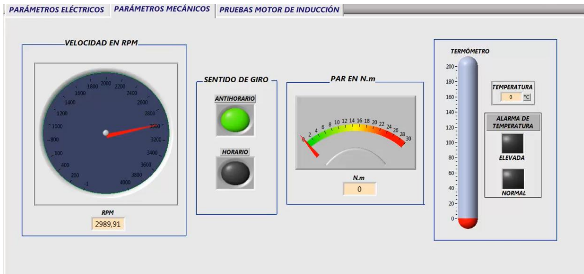
Figura 88. Funcionamiento del indicador de velocidad y un sentido de giro antihorario
