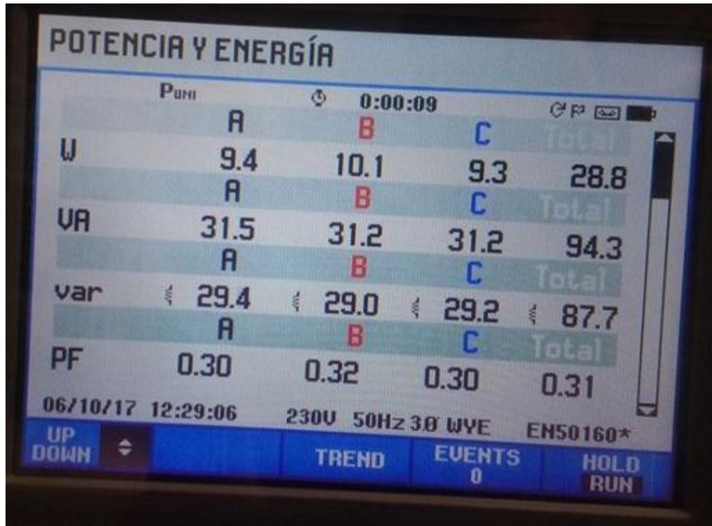
Figura 96. Datos tomados para la prueba de vacío, (analizador fluke)
