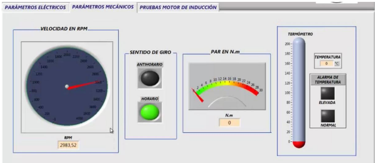
Figura 89. Funcionamiento del indicador de velocidad y un sentido de giro horario.
