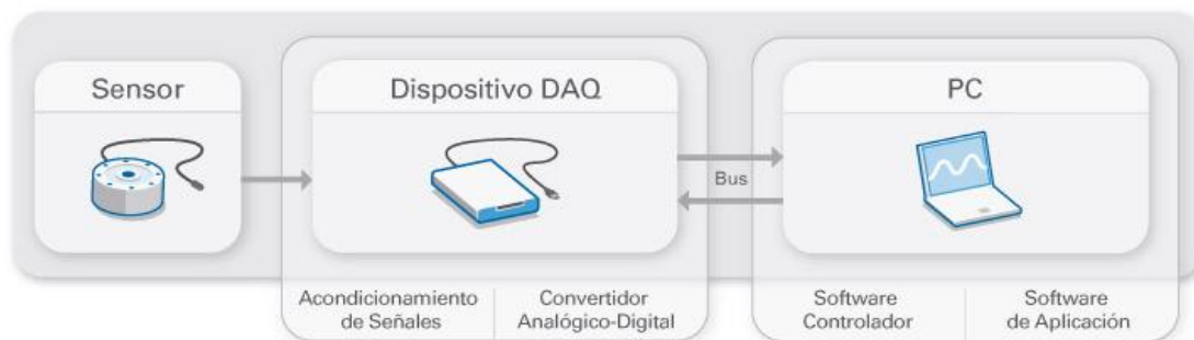
Figura 14. Partes de un sistema DAQ [4].
