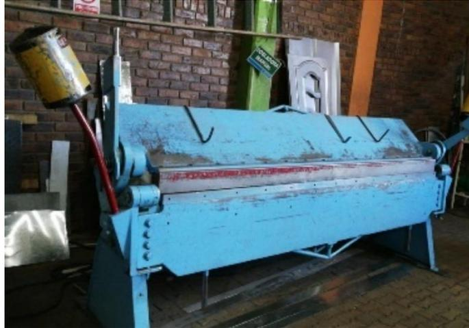
Figura 4: Máquina dobladora de lámina manual marca MAQUINCOL, especial para dobleces a más de 90 grados en lámina hasta calibre 16 (1,5mm). (Imagen por el Autor).
