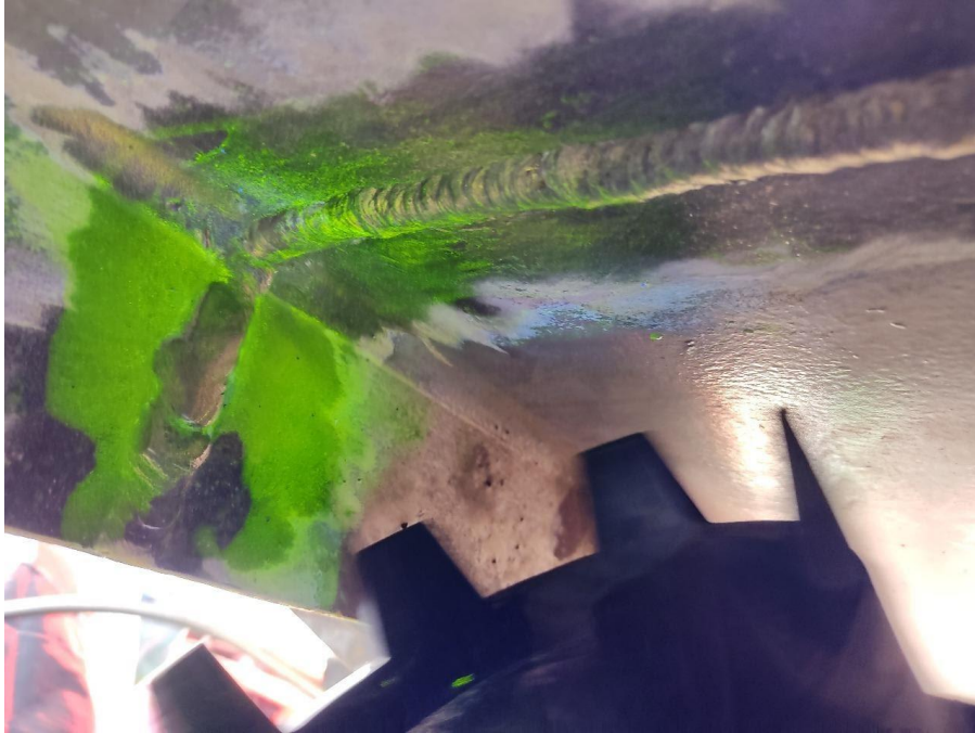
Ilustración 33. Visualización partículas magnéticas.
