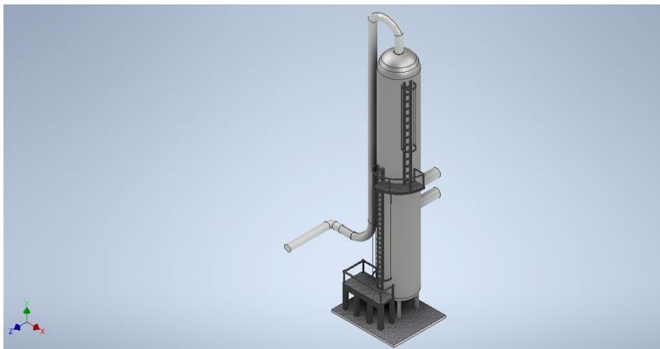
Fig. 28. Columna de destilación.
