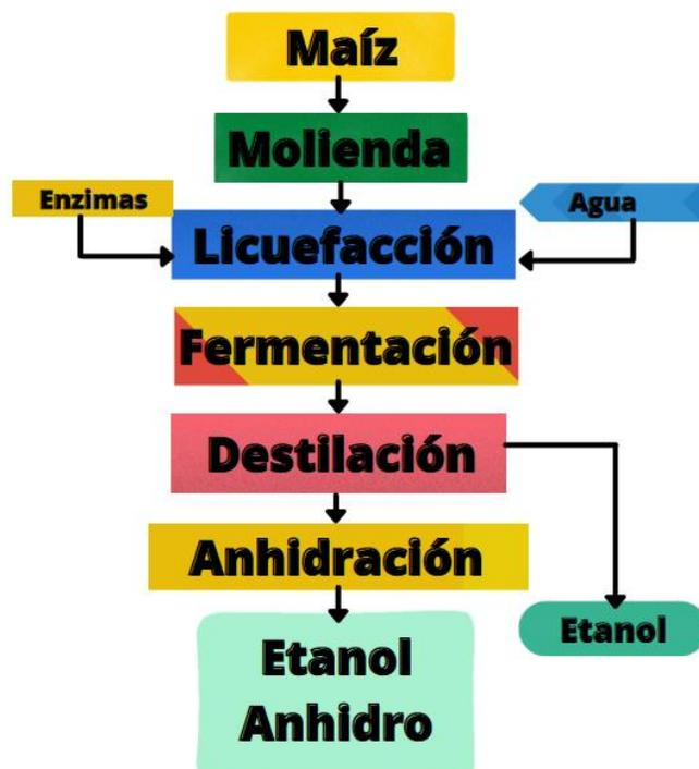
Fig. 3. Operaciones del proceso de producción.
