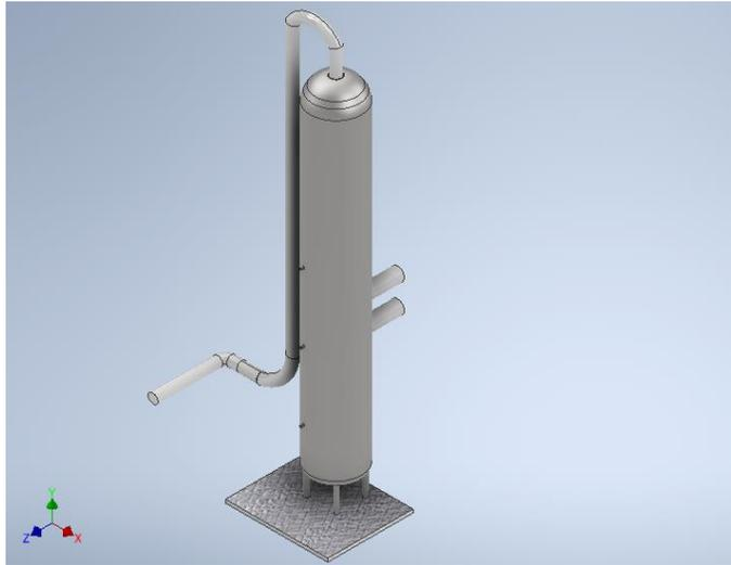
Fig. 27. Tuberías y estructura base de la torre
