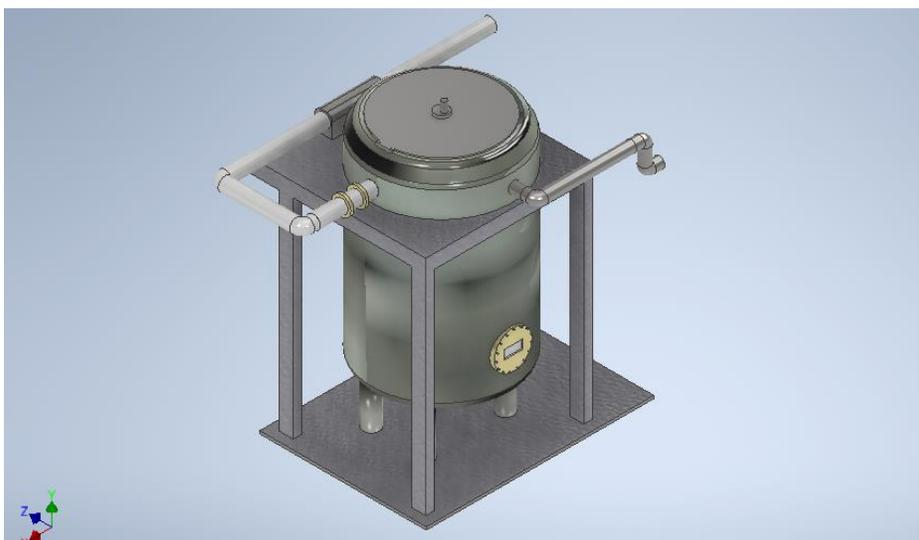
Fig. 22. Estructura y tubería de ingreso - salida.
