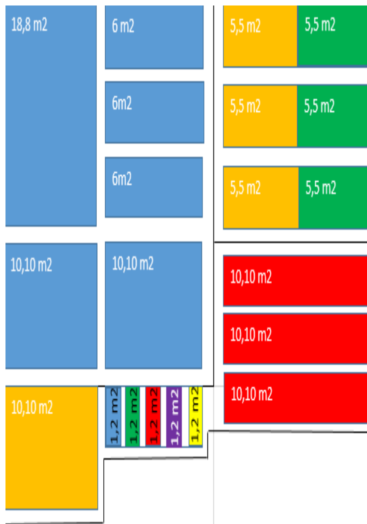
Ilustración 9. Diseño y distribución de planta para la sucursal de la empresa Agua y Refrescos las Palmas
