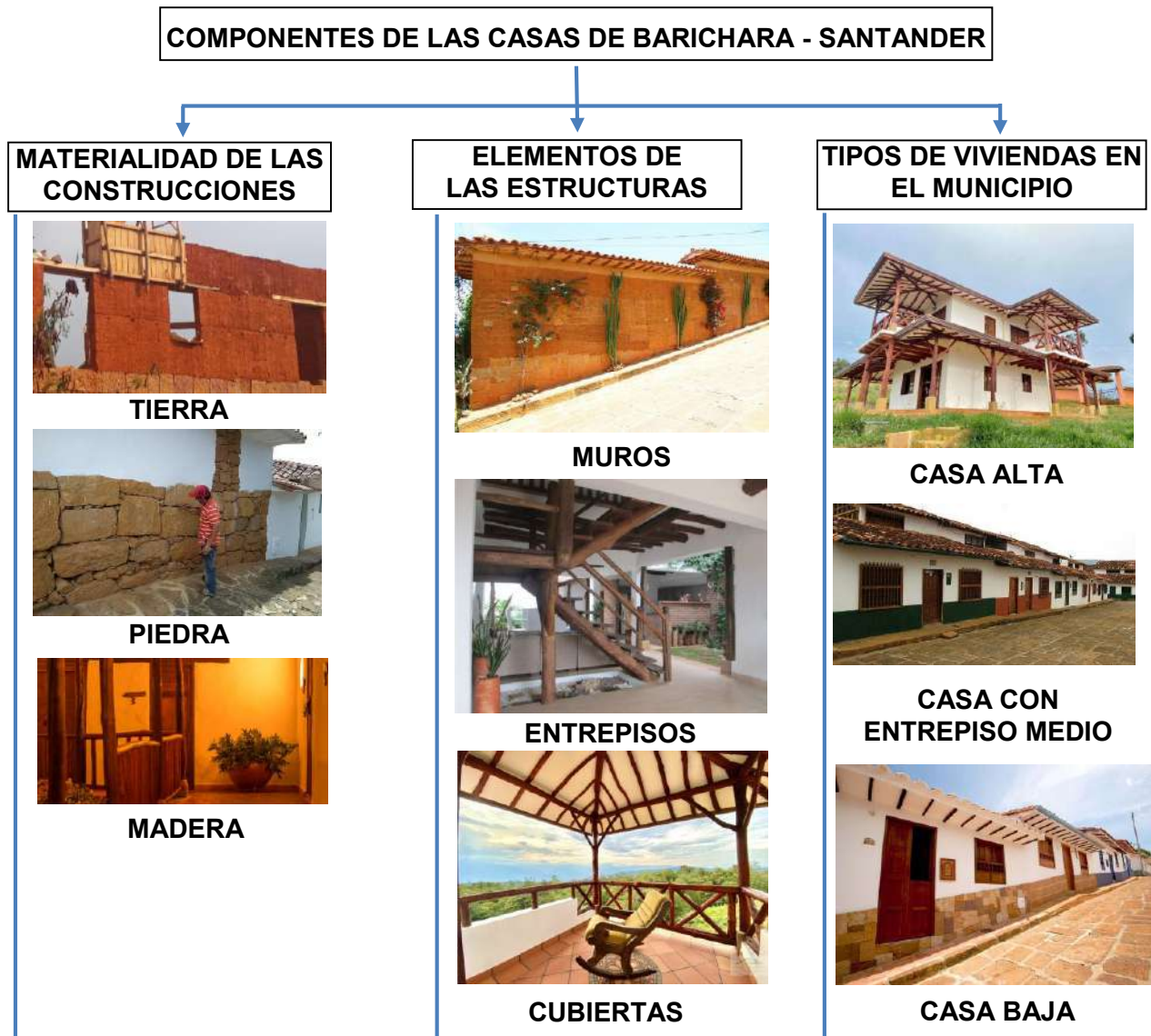
Esquema 3: Estructuración de las casas coloniales de Barichara.
