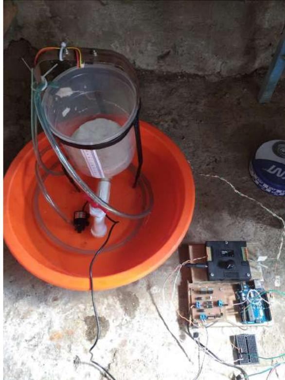
**Figura 5.37:** Montaje de la planta de control de Nivel
