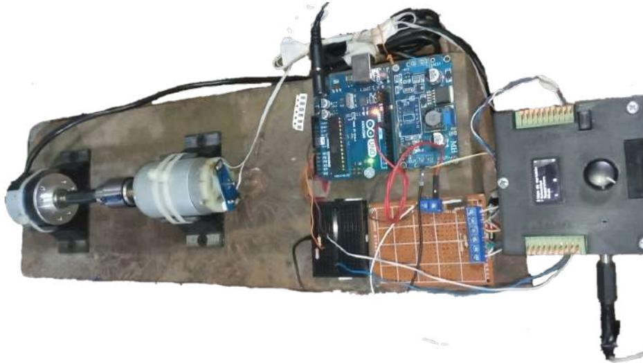
**Figura 5.34:** Lazo Control Planta Velocidad
