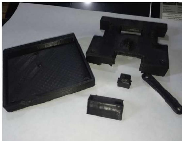
**Figura 6.4:** Piezas del case con impresión 3D
