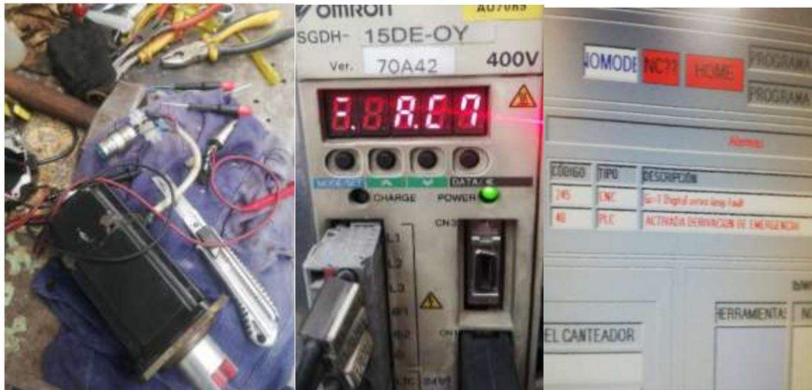
Ilustración 26- Cambio de servomotor Yukawa, por daño en encoder y problema de comunicación, con el servo pack, se evidencia alarma, autor propio.
