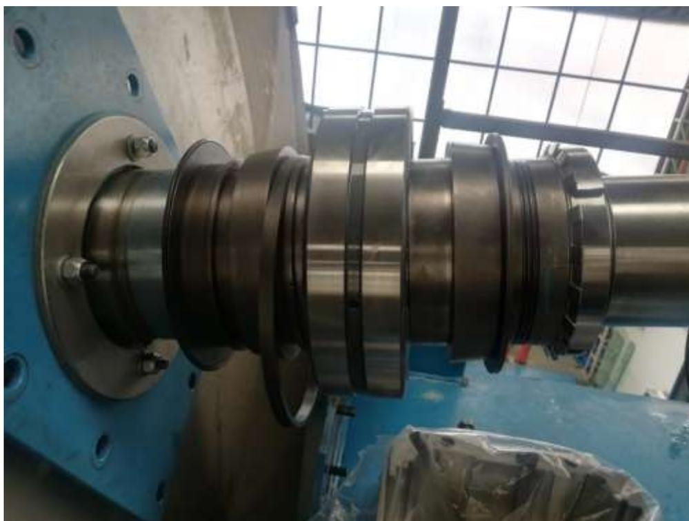
*Ilustración 48- Cambio de rodamientos de turbina principal, autor propio.*
