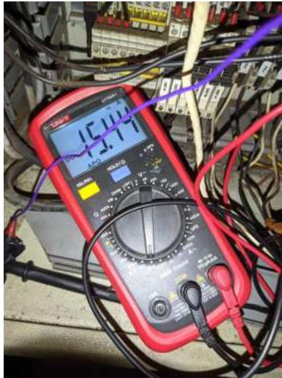
*Ilustración 43 - Medición de resistencias y termopares, para hallar causante de alarma en el sistema, autor propio.*
