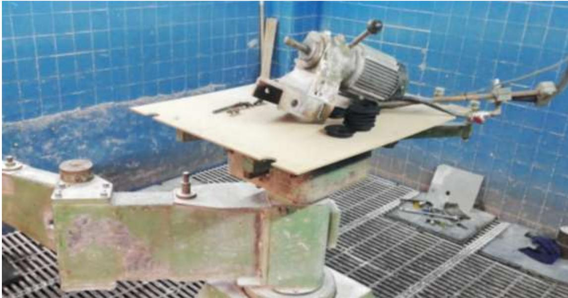
Ilustración 20- Reparación de motor, cambio de rodamientos y tornillo sin fin, autor propio.
