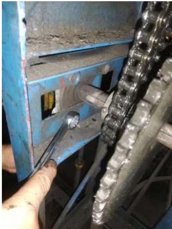
*Ilustración 52- Cambio de rodamiento y relación piñón-cadena, autor propio.*
