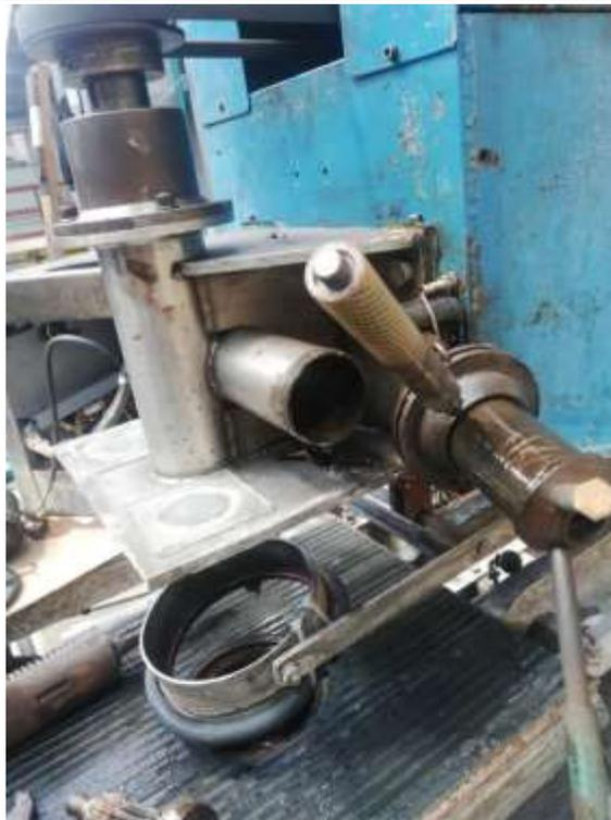
*Ilustración 30- Cambio de rodamientos, eje del mandril superior, y rectificación de manivela desplazante, autor propio.*
