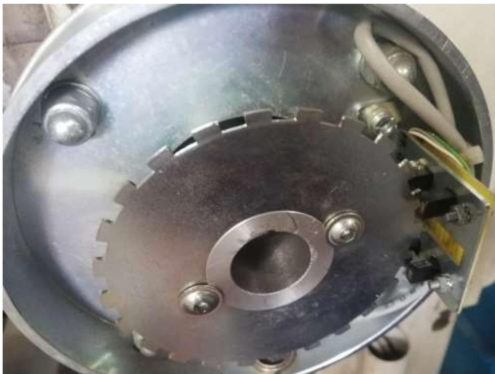
*Ilustración 47- Revisión de contador de vueltas y cambio de sensor tipo U, autor propio.*
