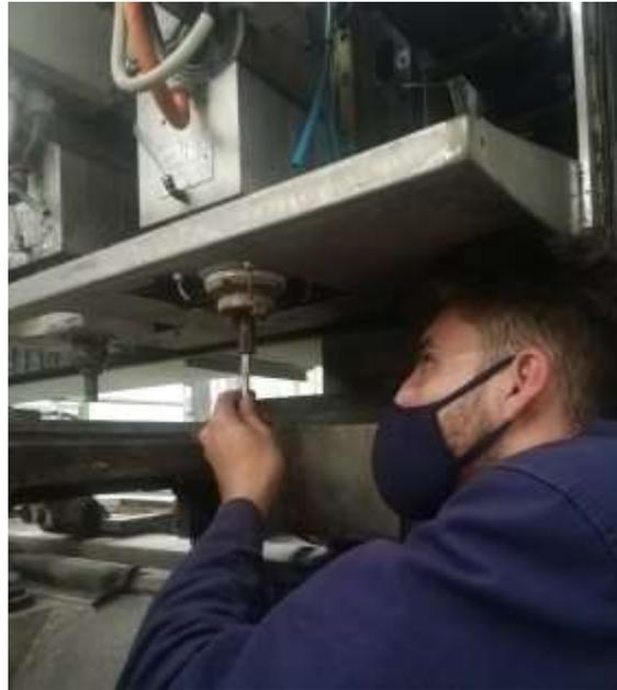
Ilustración 25- Cambio de pinza de sujeción, del mandril Z7, autor propio.
