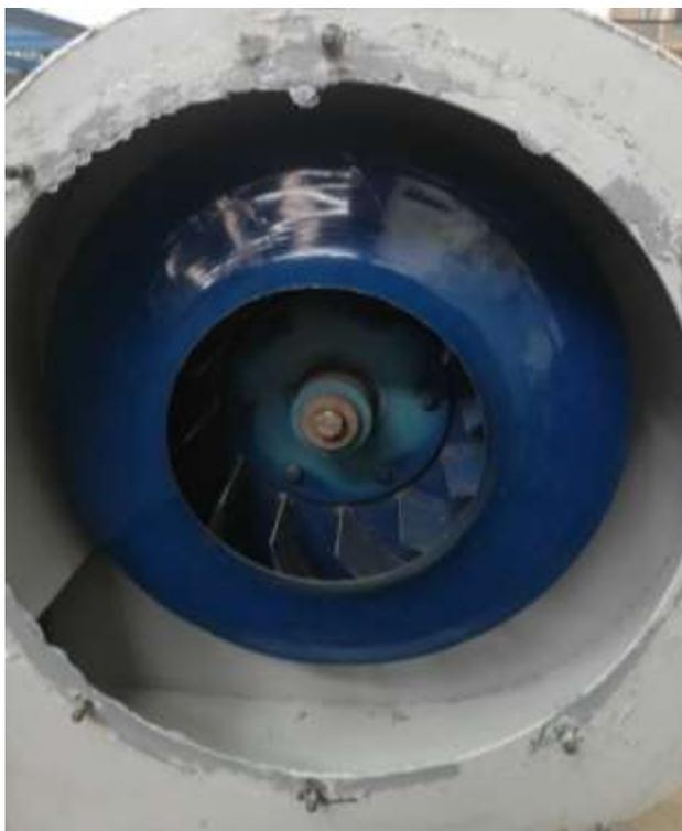
*Ilustración 39- Cambio y balanceo dinámico, turbina, autor propio.*
