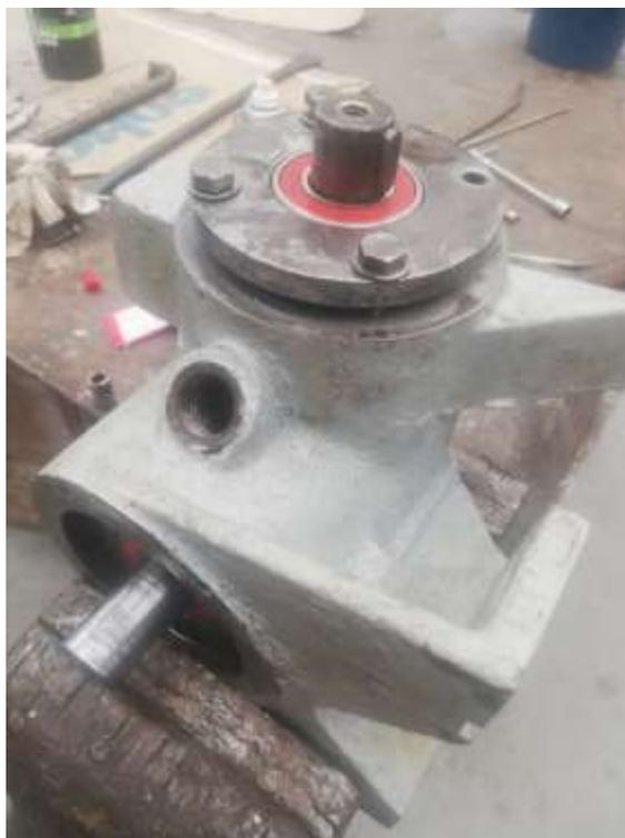
Ilustración 17- Cambio de rodamientos, transmisión transporte de vidrio, autor propio.
