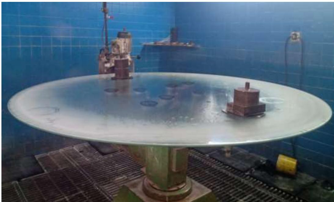
*Ilustración 18- Máquina de pulido especial, autor propio.*
